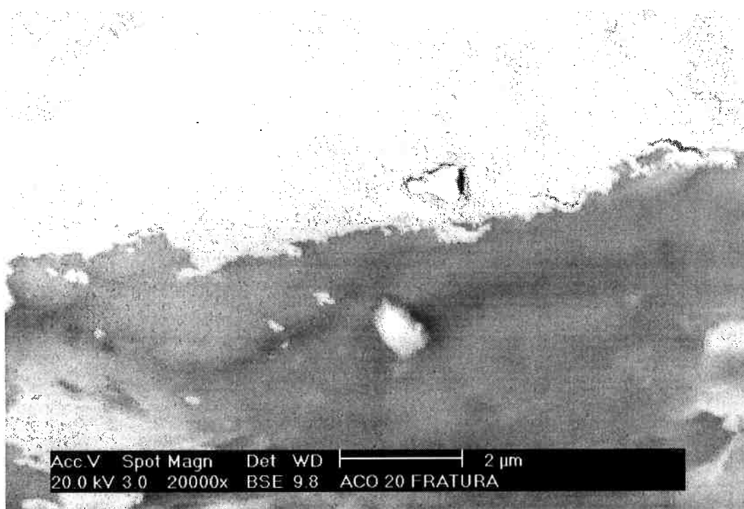
Figura 5.15: Fratura da chapa de aço com 2500x. Interface, usando BSE.
