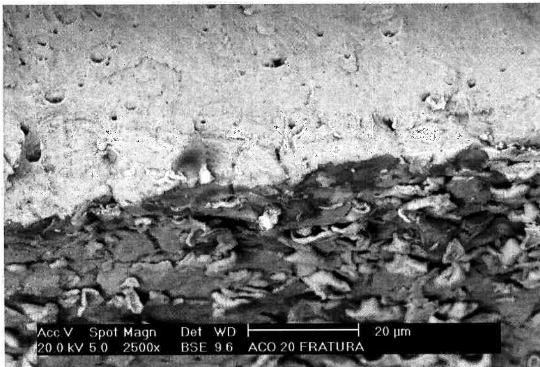
Figura 5.14: Fratura da chapa de aço com 2500x. Interface, usando BSE.
